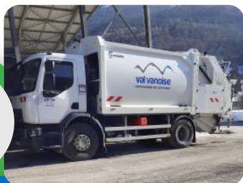
Camion Benne à Ordures Ménagères (BOM)
