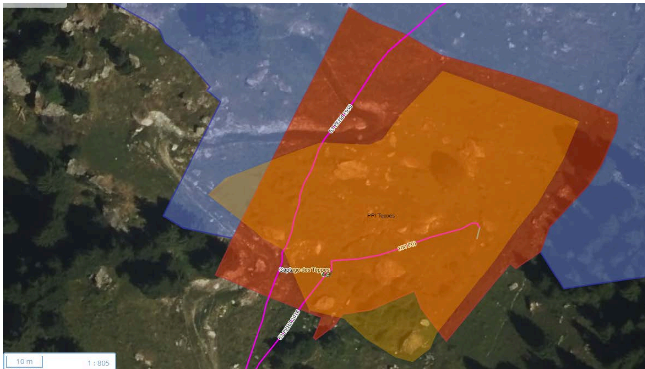
Captage des Teppes, au-dessus des Champagny-le-Haut . en rouge : le périmètre de protection immédiat devant être clôturé en orange : la zone actuellement clôturée
